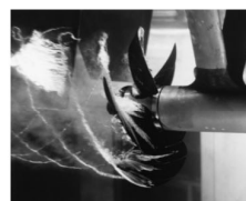
水槽試験でのプロペラキャビテーション
