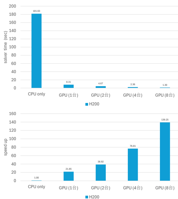
図 5 H200 搭載計算機 1 回の線型ソルバーにかかった時間(上)と CPU 計算に対するスピードアップ(下)
