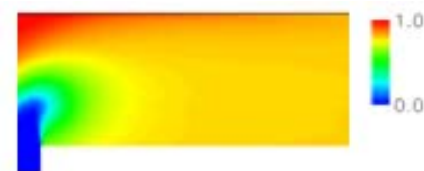
(2) RNG k- \epsilon モデルによる無次元平均温度
